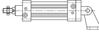
Eklem yer bağlantı Swivel flange mounting with clevis foot
